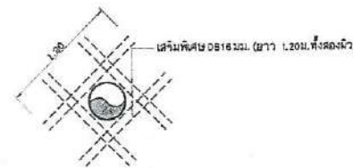
ขยายการเสริมเหล็กช่องท่อผ่าน 1 : 25
